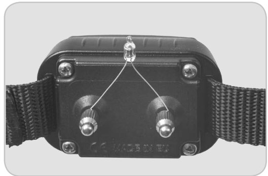
Fixierung der Neonprüfrohrendrähte an die Kontakte
