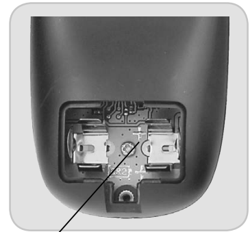
Kennzeichnung der Batteriepolareität
